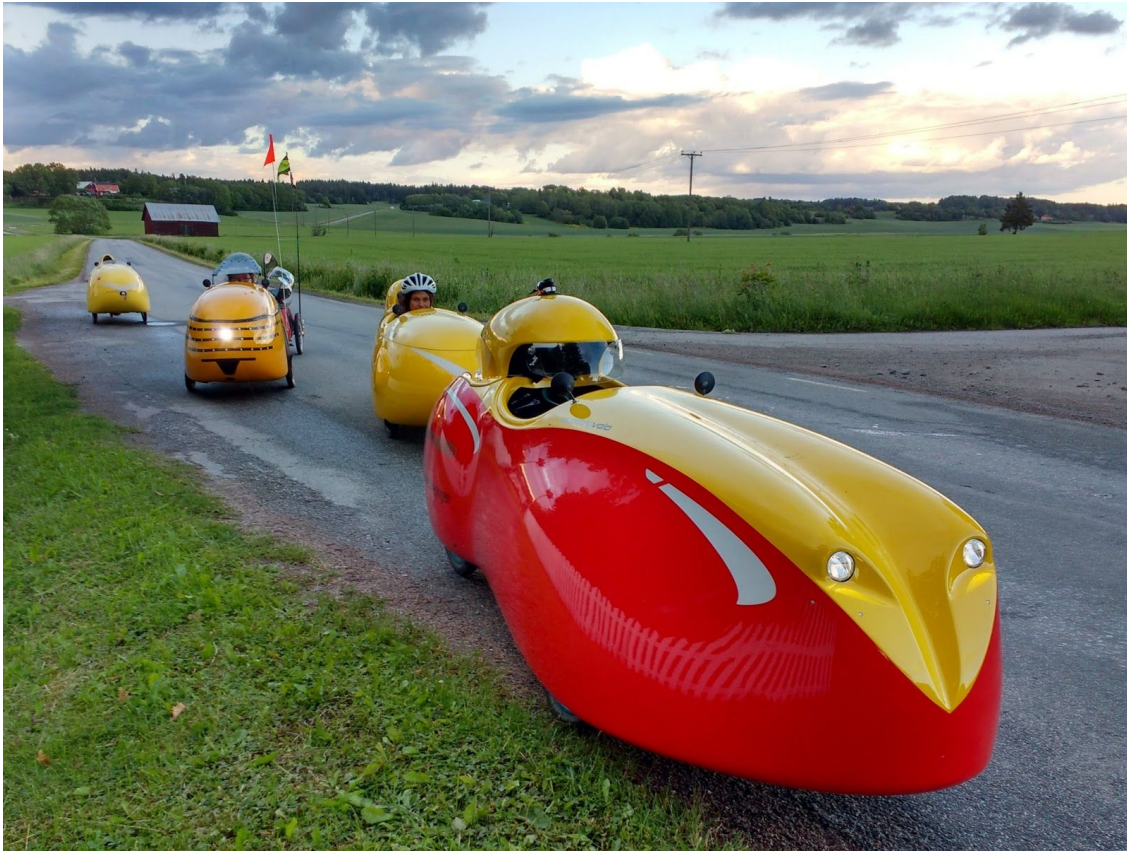
Velomobiler utanför Dalby. En aerodynamisk väderskyddad cykel som kan gå i 40-50 km/h
